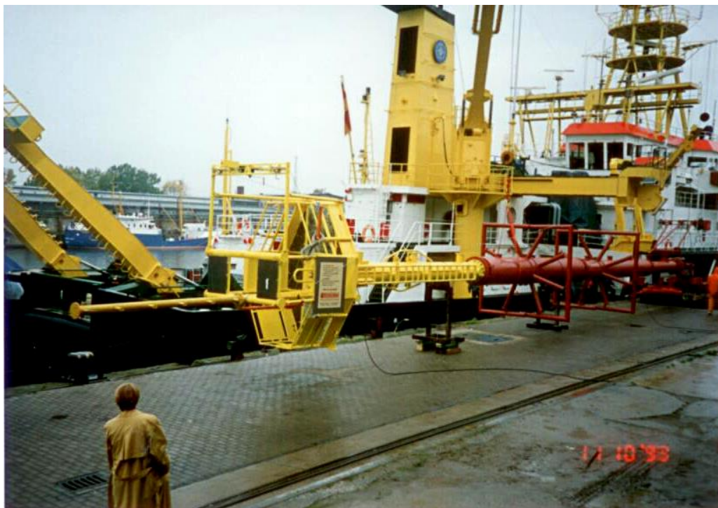
Abb. 20: Die zweite Generation des Messmastes aus dem Herbst 1993 an der Pier des Fischereihafens in Rostock bei der Vorbereitung zum Transport auf dem Vermessungs- und Forschungsschiff „Gauss“ (Fotos: W. ROEDER).
