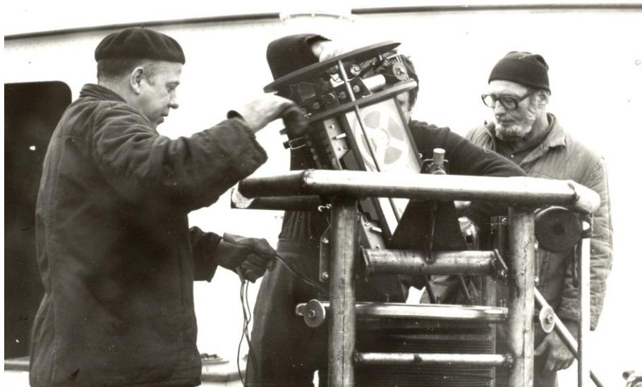
Abb. 28: Dr. F. MÖCKEL und Dipl.-Ing. H. SEEHASE (links) im November 1983 beim Auslesen der Registriereinrichtung zur Erfassung von Geräuschprofilen im Flachwasser (Foto: I. MÖCKEL).
