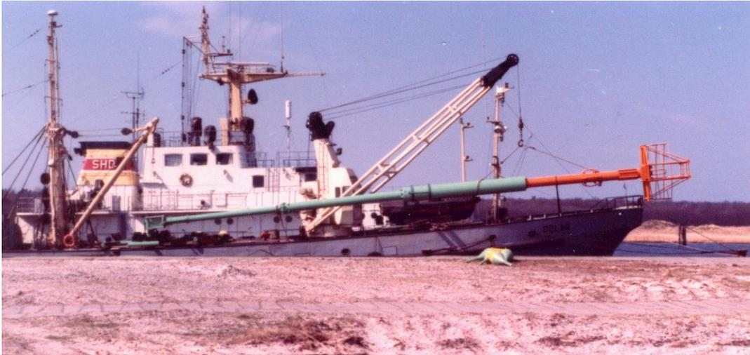
Abb. 23: Transport des Messmastes in komplettem Bauzustand auf dem Hebeschiff „Polar“ im Jahre 1989 aus dem damaligen Schnellboothafen am Darßer Ort zum Auslegen auf der Darßer Schwelle (aus: IOW 1990,2).
